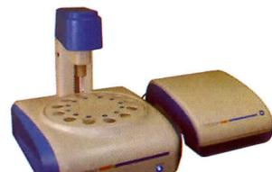
**SmarTongue 型电子舌**：又称味觉分析仪，用于液体或半固体的样品的味觉分析，是由交互敏感传感器阵列、信号采集电路、模式识别等的数据处理方法组成的现代化定性定量分析检测仪器。
