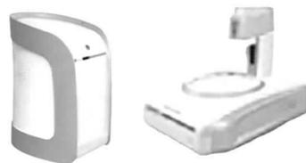
Inose 型电子鼻：又叫气味分析仪，由多个独立的金属氧化物半导体传感器组合成传感器阵列，检测精度高，检测速度快，检测效果稳定等特点，广泛用于食品，饮料，香精香料，环保，化妆品，药品，细菌学，医学诊断等领域
