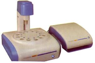
**SmarTongue 型电子舌**：又称味觉分析仪，用于液体或半固体的样品的味觉分析，是由交互敏感传感器阵列、信号采集电路、模式识别等的数据处理方法组成的现代化定性定量分析检测仪器。
