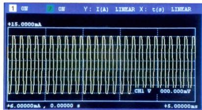
進行車用電子裝置(ECU)功能測試時，工程師需模擬ECU實際運作模式中近似實際感測器特性的類比輸入信號。
