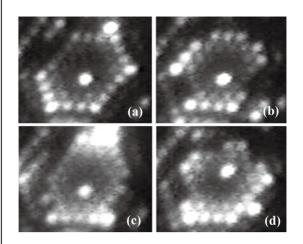
場離子顯微術是世界上最早可以進行原子 動態觀察的技術。圖中顯示的是鎢 (111) 表 面的動態事例。
