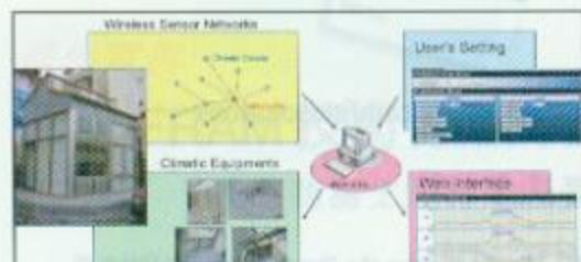
在智慧建築中，透過感測網路的佈建，我們可以即時收集環境的溫度、濕度等氣候資訊。就如同身體的皮膚一樣，具有感知的功能。透過PMV-EER技術，我們可以適當地調整環境的熱舒適狀態。如同當身體感覺冷或熱時，會採取各種方式來維持正常狀態一樣。如此一來，建築就像是被賦予智慧一般，可以依據環境的變化，調整成最具舒適節能的環境。
